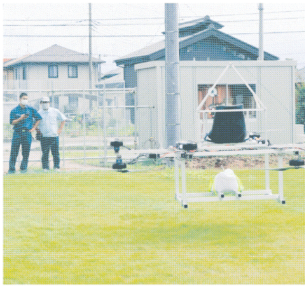
重りを載せて安定性の実験を行う生徒たち
